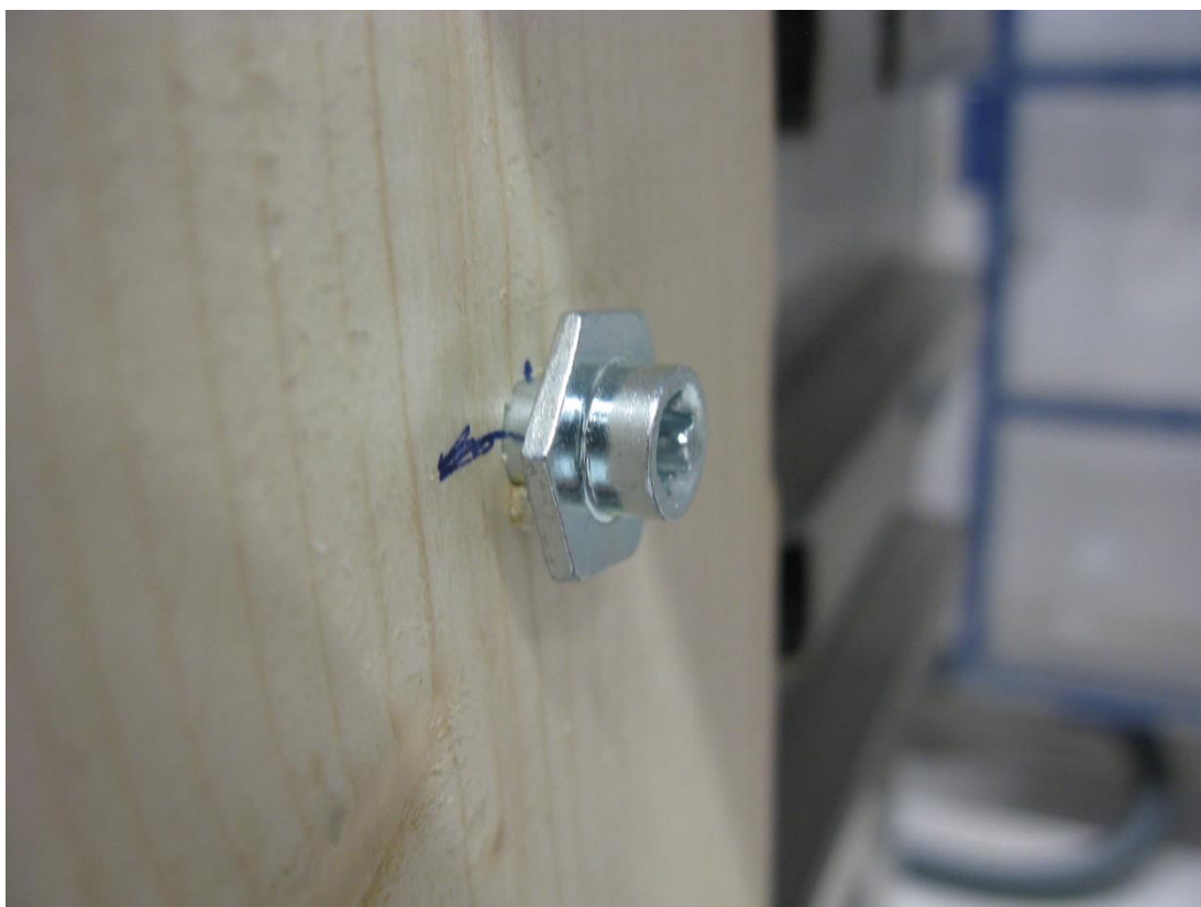
Bild 2: Montageskruvarna monterades direkt in i testriggens virke.
