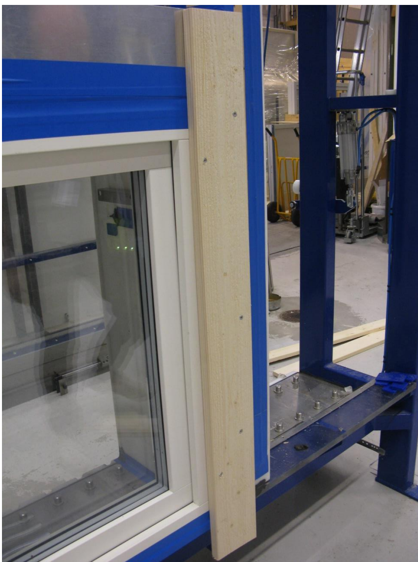
Bild 4: Fasad brädor monterades på fönstret som extra stöd, provning 1, och plockades bort för de andra provningar.
