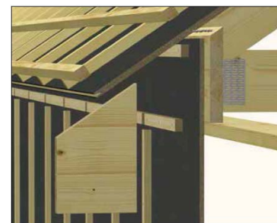
Seinän ja katon liitos, erilliset aluspuut
