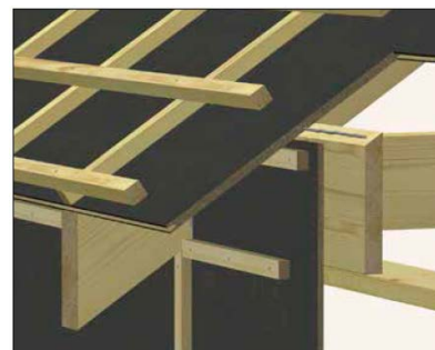
Seinän ja katon liitos, räystäälle jatkuvat yläpaarteet
