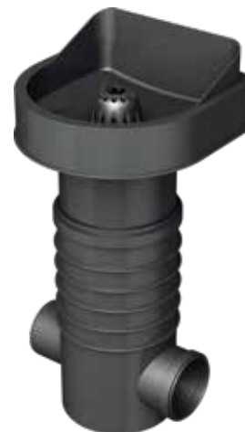
Syöksytorven alle asennettava kaivo, jossa vesitiivis pohjaosa, 2 x 110 liitokset, roiskesuoja, sorapesä ja irrotettava sihtiosa. Teleskooppirakenteen avulla korkeus on säädettävissä.
