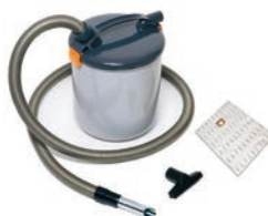
80603 Esierottelija, teräs 80604 Esierottelija, muovi Veden, hiekan, sahanpurun, askartelu-jätteen, karkeiden roskien jne. imu-rointiin käytettävä lisävaruste. Sisältää: Imuletku 3 m, metalli-, tekstiilisuulake, pölypussi, muovi/teräsastia, ylitäytön-estin, pestävä suodatin. Tilavuus 20 l. Korkeus 40 cm. 80691 Esierottelija suodatin 80688 Esierottelija pölypussi
