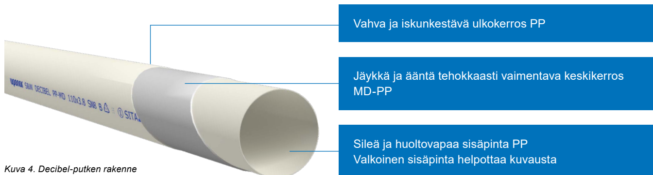
Kuva 4. Decibel-putken rakenne
