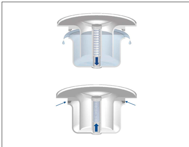
Kuva 81. Erikoisvesilukon toimintaperiaate
