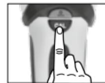
Laitteeseen saadaan suurin mahdollinen herkkyys, kun pidät laitteen kalibroinnin aikana ilmassa. Tämä saattaa joskus olla järkevää METAL- ja AC-SCAN-mittauksia tehtäessä.
