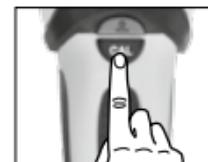
Enheten når sin maximala känslighet, när den hålls i luften under kalibreringen. Det kan vara motiverat vid METAL- och AC-SCAN-mätningar.
