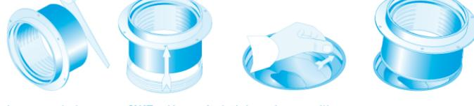
**FI:** Katkaise korokerengas haluttuun mittaan. Sahaan suoraan. Paina val- koinen tukirengas pohjaan asti. Tar- kista, että kaivon tiiviste on puhdas ja pöörikallioinen. Paina korokerengas kaivoon viinoissa asennossa. Liuku- ine helpottaa asennusta. Jos kaivo ja korokerengas valetaan betoniin sa- manaikaisesti, sido ne yhteen tuki- laipojen reikien kautta sidontalan- galla. Aseta kaivon valusuoja kor- kerenkaseen valunjakaksi. Avaa tar- vittaessa sivuliittäntä.
