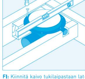
**FI:** Kiinnitä kaivo tukilaipastaan lat- tiapalkkeihin kolmelta sivulta. Älä teoh pohjasta. Avaa tarvittaessa si- vuliittäntä lyömällä typlällä tapilla. Tee 170 mm aukku lattialevyn ja kiinnitä levy 6:lla 4x50 mm ruu- villa tukilaippaan. Varo, etteivät ruu- vit osu putkiin. Täytä kaivon ja levyn välinen rako elastisella massalla.
