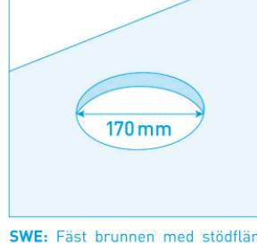
**SWE:** Fäst brunnen med stödflänsen på tre sidor i brunnskortlingarna. Stöd inte i bottnen. Öppna vid behov sidoanslutningarna genom att slå med en trubbig tapp. Gör en 170 mm stor öppning i golyskivan och fast skivan med 6 4x50 mm skruvar i stödflänsen. Se upp med att skruvarna inte träffar rören. Fyll springan mellan brunnen och skivan med elastisk massa.
