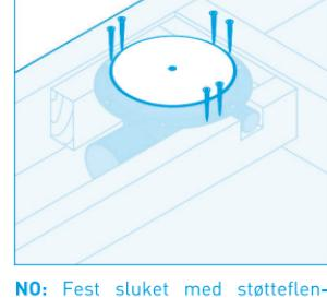
**NO:** Fest sluket med støtteflensen, denne skal understøttes. Støtte trengs ikke i bunnen. Sideinnløpene åpnes ved å banke med en stump tapp. Gjør en 170 mm stor åpning i sponplaten og fest platen med 6 4x50 mm skruer ned i støtteflensen. Se til at skruene ikke treffer rørene. Fyll ut mellomrommet mellom sluket og platen med elastisk masse.
