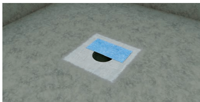
2. Poista toinen puoli läpivientikappaleen suojapaperista ja aseta WetStop MG keskelle kaivoa (varo kuljettamasta vedeneristettä kaivon reunojen sisäpuolelle).
