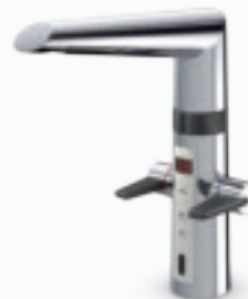
Oras nro. 2727F, LVI-nro 6219076 Älykäs keittiöhana, jossa kosketusvapaa toiminto, lämpötilanäyttö ja astianpesukoneventtiili. Sähköliitäntä pistotulppamuuntajalla 230/5 V.
