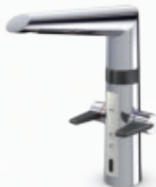
Oras nro. 2725F, LVI-nro 6219074 Älykäs keittiöhana, jossa kosketusvapaa toiminto ja astianpesukoneventtiili. Paristokäyttöinen (3 V)
