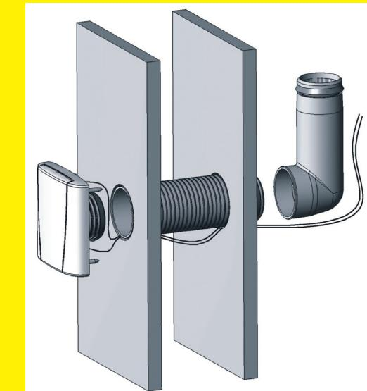
**FI:** Mikäli kansiasennelman holkki ei ylety kulmayhteesseen, käytä apuna jatketta. Jatkeen pituus on 13 cm. Katkaise jatke sopivan mittaiseksi ja paina kulmayhde ja pölyputki tiukasti seinälevyä vasten. Tarvittaessa jatkeita voi käyttää useampia peräkkäin. Liitä pienjännitejohtimet ja paina kansiasennelma paikoilleen. Kiinnitä ruuvit. **Paina pölyputki kulmayhteen jyrkkään 90° mutkaan asti.**
