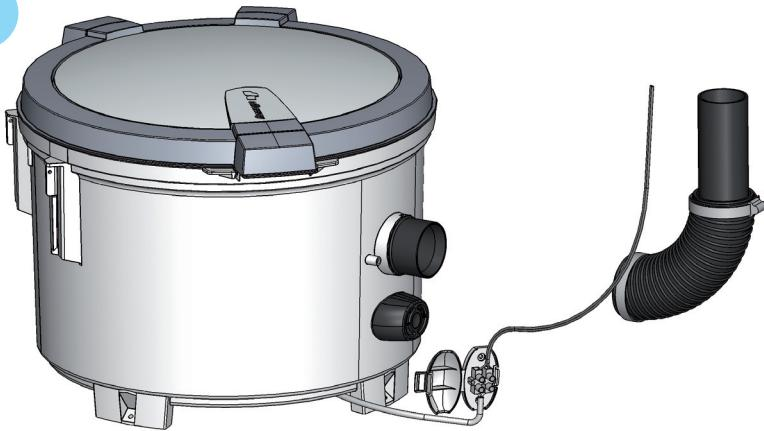
**FI:** Duon voit asentaa joko pysty- tai vaaka-asentoon. Huomioi että Duon imuyhde ja mahdollinen imurasia ovat laitteen keskilinjan tasolla tai yläpuolella, jotta imuroitu pöly ei valu takaisin putkistoon, kun laite sammutetaan. Kuvassa 4 on esitetty Duon vaatima tila vähintään. Duon mukana tulee eri seinärakenteisiin soveltuva teline, jonka asennukseen on ohjeet Duon käyttö- ja huolto-ohjeessa. Huomioi seinämateriaali ja seinän paksuus valitessasi kiinnitysruuveja.
