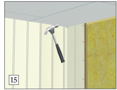
15) Naulaa levy tällä tavalla. Levyt naulataan reunassa viimeistelynaulalla siten, että naulaus jää näkyviin. Ylä- ja alakulma voidaan naulata tavallisella naulalla. Paikkamaalaa näkyviin jäävien viimeistelynaulojen kannat alku-peräistä vastaavalla värillä. Käytä paikkamaalauspullon korkin sivellintä (ks. alla näkyvä kuva).
