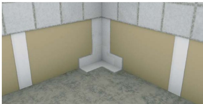
3. Vedeneristenauha käsitellään SCHÖNOX HA / Casco AquaStop -vedeneristeellä.
