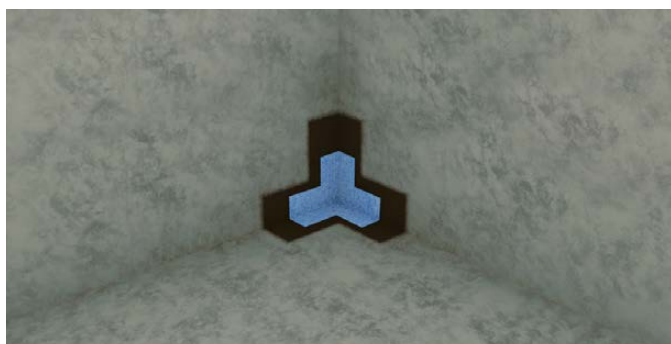
2. Paina WetStop PC/PC-e -nurkkakappale kiinni tuoreeseen vedeneristeeseen siten, että kaikki ilma poistuu kappaleen alta. Jos nurkka ei ole täysin suorassa ja nurkkakappaleeseen syntyy pussi, pyri ohjaamaan pussi tulevan limityksen alueelle ja tee sinne viilto.
