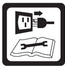
Irrota sähkövirrasta. Irrota sähkövirrasta, kun kone ei ole käytössä, ennen säätöjen tekemistä, osien vaihtamista, puhdistamista tai puunhalkaisukoneen huoltamista. Tutustu tekniseen käyttöoppaaseen ennen huoltamista.
