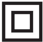
Данное устройство оснащено двойной изоляцией для дополнительной защиты.
