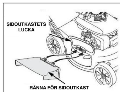
**Endast bioklippning** Ta bort sidoutkastets ränna.
