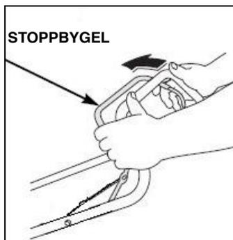
**!** **VARNING!** Kniven fortsätter att rotera under några sekunder efter att motorn har stängts av. Koppla från tändstiftshatten om gräsklipparen ska lämnas utan uppsikt.
