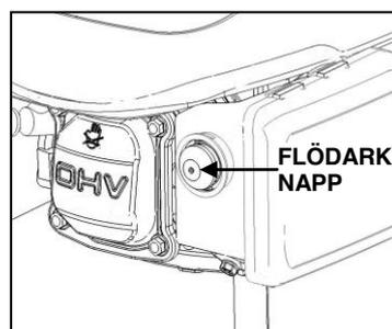
Du bör även sätta till mer bränsle i luftblandningen för att underlätta start. När du trycker på flödarknappen pumpas bränsle direkt från förgasaren till förbränningskammaren.
