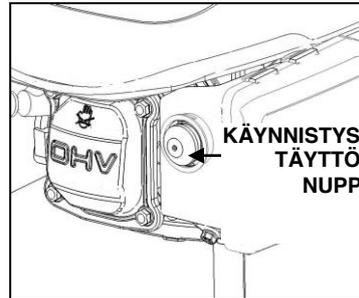
Käynnistykseen helpottamiseksi polttoaineen osuutta voi myös nostaa imuilmassa. Käynnistystäyttö-nuppia painettaessa polttoainetta pumpataan suoraan kaasuttimesta polttokammioon.
