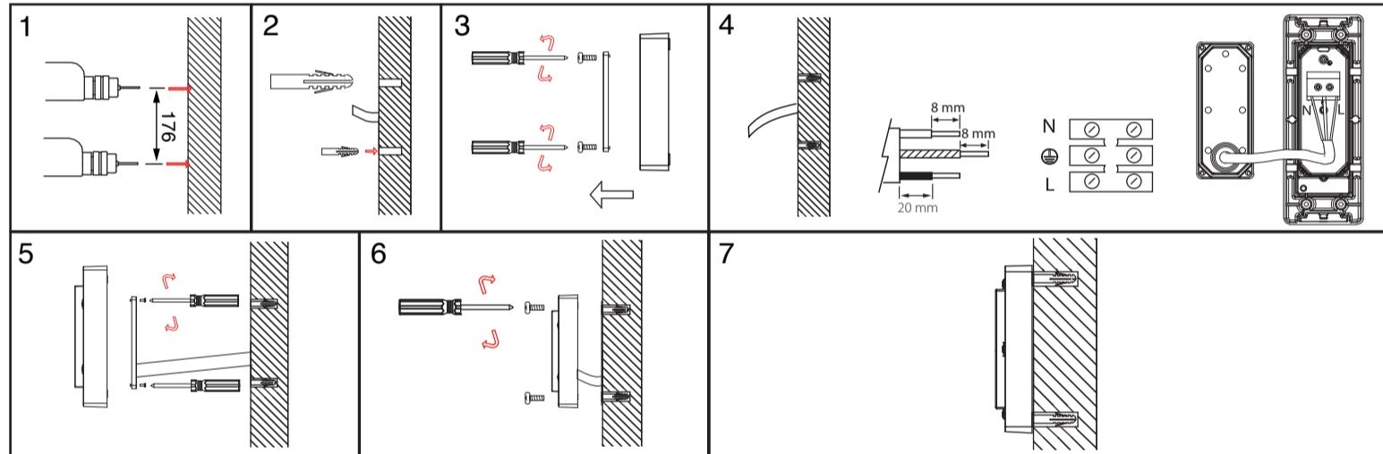
Uppoasennus | Infädd montage | Süvispaigaldus | Recessed mounting
