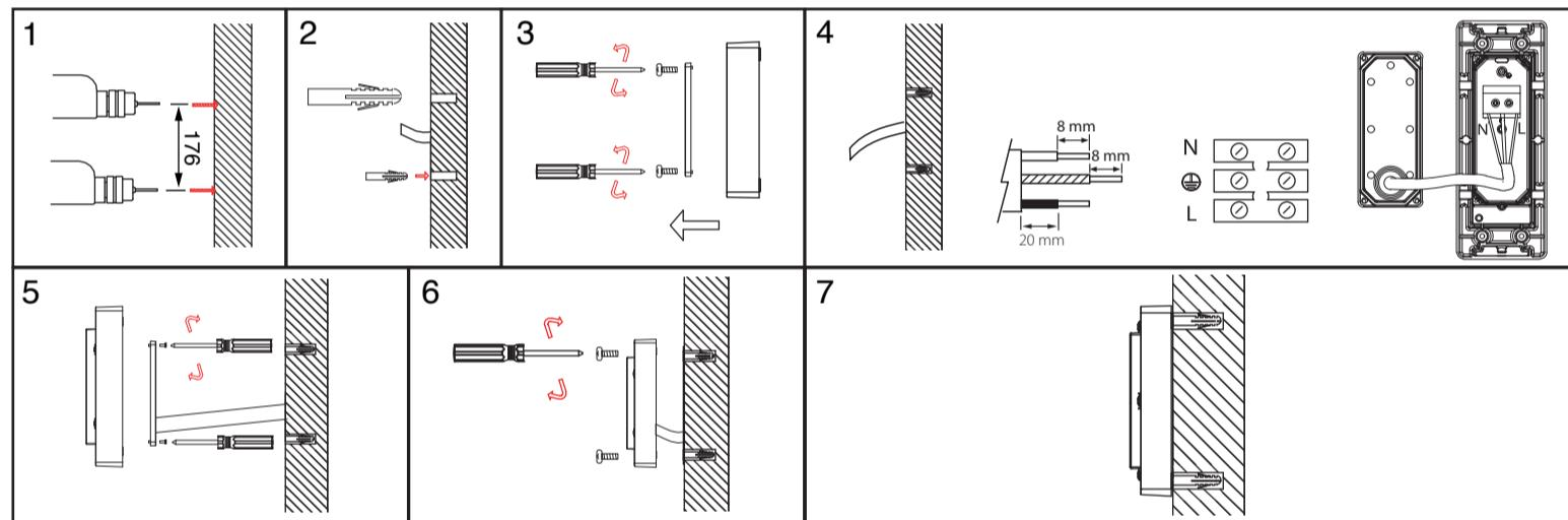
Uppoasennus | Infälld montage | Süvispaigaldus | Recessed mounting
