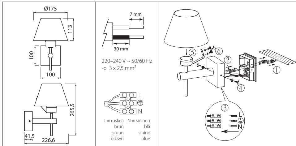
Valaisimen saa asentaa vain sähköalan ammattilainen. Käytä ainoastaan syöttöjännittää ja tajauutta joka on merkity. Kytke virta pois päältä ennen asennusta tai huoltoa. Valonlähettä ei voi vaihtaa (⚠️). Vaihda tilalle uusi valaisin, jos valonlähde rikkoutuu. Tämä asennusohje on säilytettävä ja sen on oltava käytössä asennuksessa ja huollossa.
