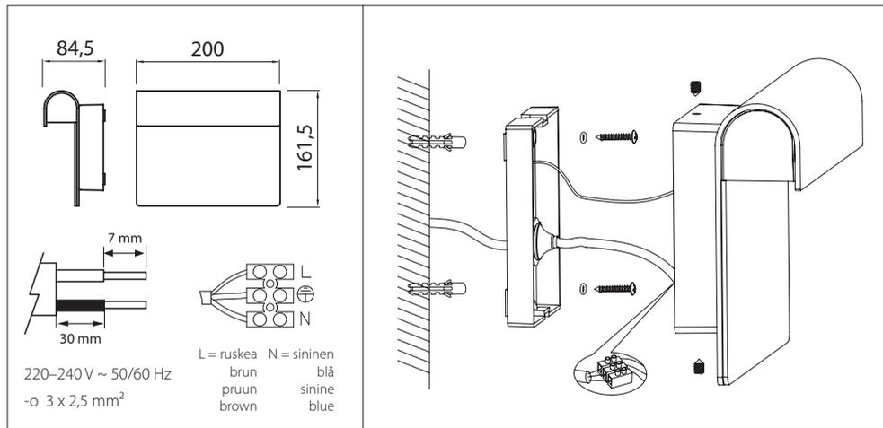
Valaisimen saa asentaa vain sähköalan ammattilainen. Käytä ainoastaan syöttöjännitettä ja taajuutta joka on merkitty liitälaitteeseen. Kytke virta pois päältä ennen asennusta tai huoltoa. Valonlähde ei voi vaihtaa. Vaihda tilalle uusi valaisin, jos valonlähde rikkoutuu. Tämä asennusohje on säilytettävä ja sen on oltava käytössä asennuksessa ja huollossa.
