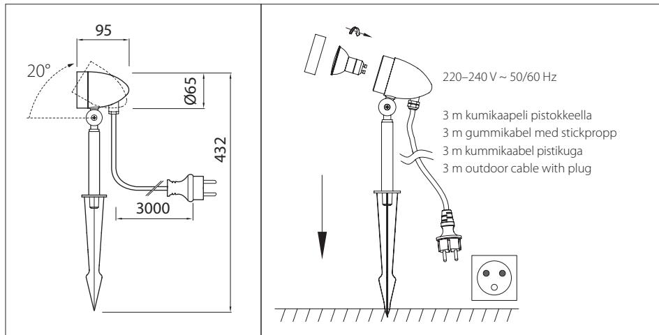
Käytä ainostaan valonlähettää ja tehoa, joka valaisimeen on merkity. Kytke virta pois päältä ennen asennusta tai huoltoa. Liitintäjohto ei voi vaihtaa eikä korjata. Mikäli johto vaurioituu, on valaisin hävitettävä ja toimitettava keräyspisteesseen. Tämä asennusohje on säilytettävä ja sen on oltava käytössä asennuksessa ja huollossa.
