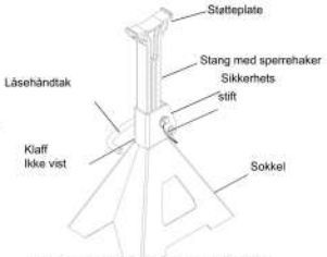
Figur 1: Bestanddelene av en vanlig jekk
