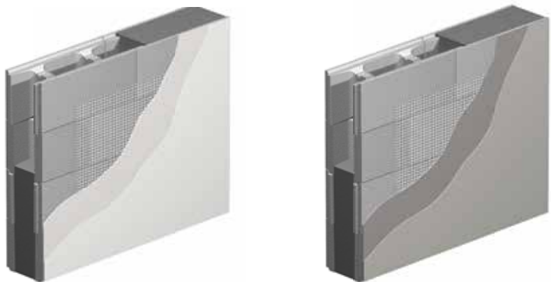
Kuva 16. Harkkoseinän pinnoitus kuivissa ja kosteissa tiloissa.
