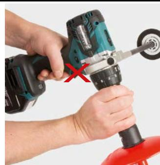
Dra åt chuckkäftarna för hand – använd INTE avtryckaren.
