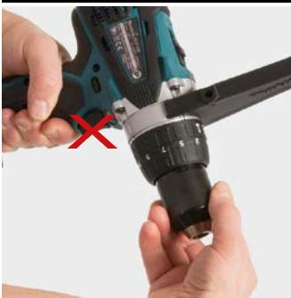
Öppna chucken för hand – använd INTE avtryckaren.
