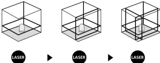
! Horisontal og vertikal nivellering krever at transportsikringen løsnes. Straks apparatet befinner seg utenfor det automatiske nivelleringssområdet på  $2,5^\circ$ , blinker laserlinjene. Posisjoner apparatet slik at det befinner seg innenfor nivelleringsområdet.
