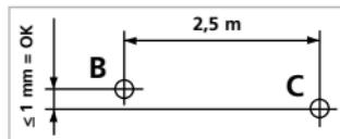
! Kontrollera kalibereringen regelbundet före användning samt efter transport och längre förvaring.
