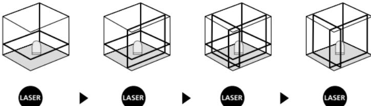
! Vaaka- ja pystysuuntaan tasaamista varten tulee kuljetusvarmistuksen olla vapautettuna. Kun laitteen kallistus on automaattisen  $2,5^\circ$  itsetasausalueen ulkopuolella, laserviivat vilkkuват. Sijoita laite tasaiselle alustalle niin, että laite on tasausalueella
