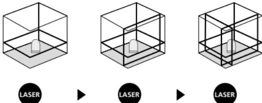
! Vid horisontell och vertikal nivellering måste transportsäkringen lossas. är apparaten befinner sig utanför det automatiska nivelleringsområdet på  $2,5^\circ$ , blinkar laserlinjerna. Positionera enheten på ett sådant sätt, att den befinner sig inom nivelleringsområdet.
