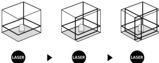
! Yatay ve düşey düzeyeleme için taşıma emniyetinin çözülmüş olması gerekmektedir. Cihaz otomatik düzeyeleme aralığı olan  $2,5^\circ$ 'nin dışında bulunduğu zaman, lazer çizgileri yanıp sönmeye başlarlar. Cihazı düzeyeleme aralığı içinde bulunacak şekilde konumlandıınız.
