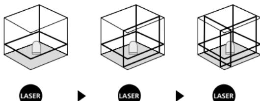
! Для горизонтального і вертикального нівелювання необхідно розфіксувати транспортне стопоріння. У разі виходу за межі діапазону автоматичного нівелювання на  $2,5^\circ$  лазерні лінії починають блимати. Розташуйте прилад так, щоб він потрапив у межі діапазону автоматичного нівелювання.
