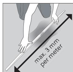
Cello Puzzle'i võib paigaldada betoonpinnale, plaatidele, puitpinnale ja suuremale osale kõvadele põrandakatetele, eeldusel et aluspõrand on sile, kuiv ja puhas. See ei sobi paigaldamiseks pehmetele põrandakatetele, st vaipadele või pehmele vinüütikattele.
