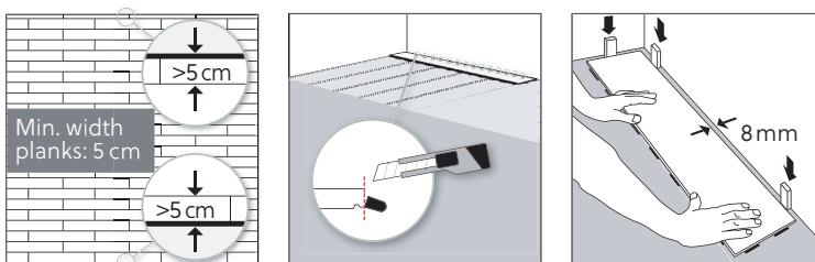
Mät rummet noggrant för ett väl avvägt utförande. Genom att mäta kan du fastställa om den första raden måste skäras. Den första och den sista raden får inte vara mindre än 5 cm breda. Om den första plankraden inte behöver skäras i bredd, måste du oavsett avlägsna låstapparna på den sida som är vänd mot väggen.
