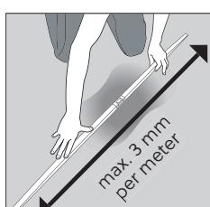
Cello Puzzle kan installeres direkte oppå betong, fliser/stein, spon- og gipsplater, samt de fleste andre undergulv med hard overflate, forutsatt at undergulvet er jevnt, tørt og rent. Cello Puzzle er ikke egnet til å installeres på teppe og myke belegg.
