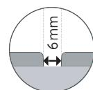
Det er ikke nødvendig å fylle fugene i et undergulv med keramiske fliser hvis fugene ikke er bredere enn 6 mm.
