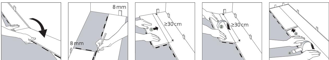
Se alltid till att kortsidorna förskjuts minst 30 cm (= 3 låstappar) när du startar nästa rad. Vid behov justeras längden på den första plankan i rad nr. 2 så att man uppnår nämnd förskjutning av kortsidoskarven på min. 30 cm.
