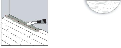
For å installere siste rad legges en løs planke nøyaktig oppå den sist lagte planken. Plasser en annen planke opp-ned vendt mot vegg (med riktig avstand til vegg), og marker radens bredde på den underliggende plankens overflate. Kutt den markerte planken i korrekt størrelse og legg den på plass. Denne metoden må gjentas for hver planke til siste rad er ferdig.
