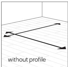
Den maksimale størrelsen på installasjonsarealet er avhengig av romtemperaturen (overflatens forventede temperatur).
