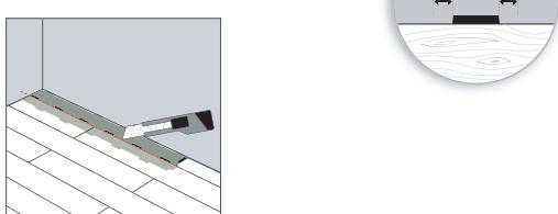
Vid installation av den sista raden läggs en lös planka exakt ovanpå den sista lagda plankan. Placera en annan planka upp och nedvänd mot väggen (med riktigt avstånd till väggen), och markera radens bredd på den underliggande plankans yta. Skär den markerade plankan i korrekt storlek och lägg den på plats. Denna metod ska upprepas för varje planka tills den sista raden är färdig.
