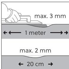
Se till att undergolvet är jämmt, med en golvnivåavvikelse på max. 3 mm pr. m och 2 mm pr. 20 cm. Skarpa ojämnheter måste slipas ned och eventuella hål spacklas. Om indikerad avvikelse överskrider måste undergolvet jämnas ut med ett lämpligt golvspackel. Om du är osäker på undergolvets kvalitet eller lämplighet för installation av Cello Puzzle, rekommenderar vi att du tar kontakt med din återförsäljare som gärna hjälper dig.
