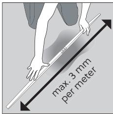
Cello Puzzle kan installeras direkt på betong, klinker/sten, spån- och gipsskivor och de flesta andra undergolv med hård yta, förutsatt att undergolvet är jämmt, torrt och rent. Cello Puzzle kan inte installeras ovanpå mattor och mjuka golvbeläggningar.
