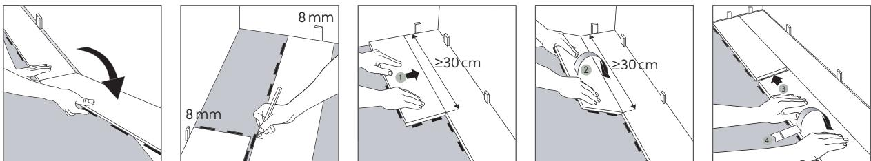
Sørg alltid for at endeskjøtene forskyves minst 30 cm (= 3 klikkelementer) når du starter på neste rad. Ved behov justeres lengden på det første plank i rad nr. 2 slik, at man oppnår nevnt forskyvning av endeskjøten på minst 30 cm.
