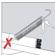
Klikkgulvet må legges fritt flytende (gi mulighet for krymp og ekspansjon i varierende romtemperatur).
