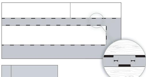
Hvis dimensjonen til rommet krever kortere plank enn 20 cm for å fullføre gulvet ditt , skal disse korte plankene limes sammen i låssystemet. De må aldri limes til undergulvet, da dette forstyrrer muligheten for ekspansjon av det flytende klikkgulvet.
