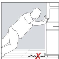
Kontorstoler med hjul, møbler, treningsutstyr etc. må utstyres med gummifri beskyttelse for å unngå permanente skader på gulvet. Bruk myke beskyttende møbelknott er i filt under stol- og bordben. Forsyn andre tunge møbler og gjenstander med filtbeskyttelse for ripesikker flytting. Bruk skrivebordsmatte i plast under kontorstol med hjul.
