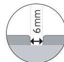
Det är inte nödvändigt att fylla fogarna på ett undergolv bestående av klinker, när fogarna inte överskrider 6 mm i bredden.
