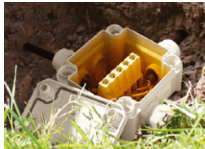
Kovettunut joustava geeli antaa veden- pitävän suojan – IP68. Geeli toimii myös johtimien vedonpoistimena.
