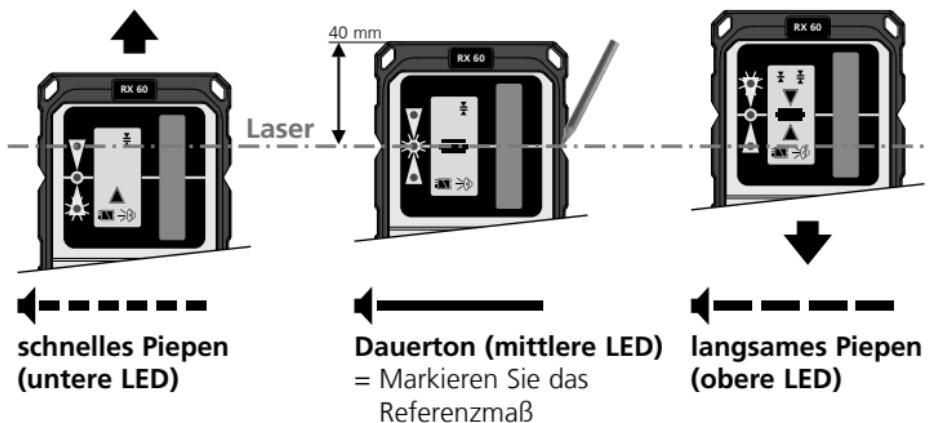
! Die Lichtintensität der Laserlinien ist in der Mitte am höchsten und wird an den Enden geringer. Dadurch kann sich der maximale Empfangsbereich des Laserempfängers verringern.
