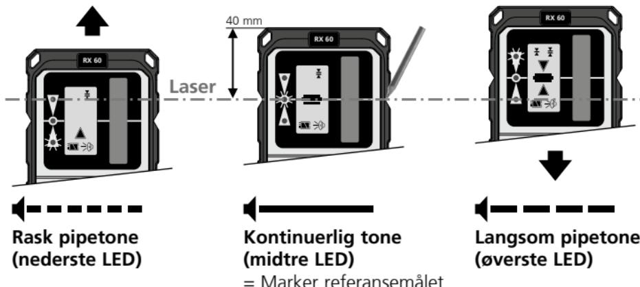
! Laserlinjenes lysintensitet er høyest i midten og blir mindre mot endene. Dette kan føre til at lasermottakerens maksimale mottaksområde blir redusert.
