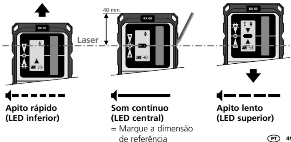
! A intensidade da luz das linhas de laser é maior no meio e menor nas extremidades. Assim é possível que a margem de recepção máxima do receptor laser diminua.
