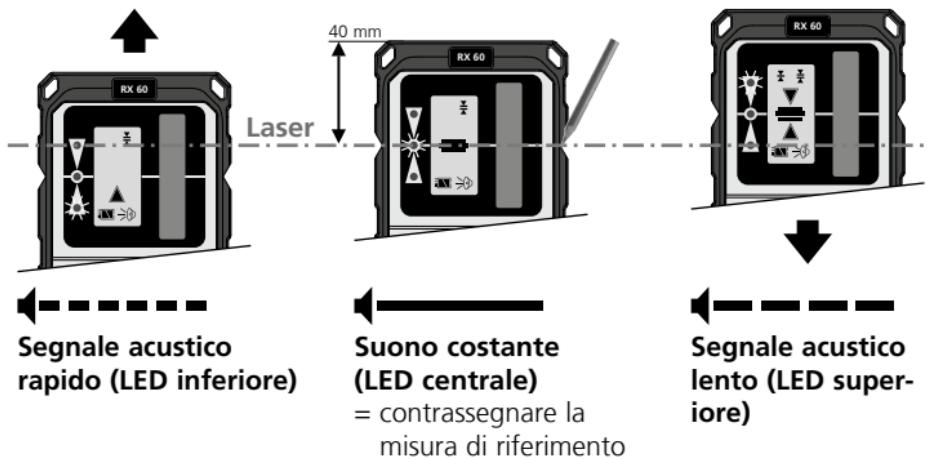
! L'intensità luminosa delle linee laser è massima al centro e si riduce alle estremità. In questo modo può diminuire l'area di ricezione del ricevitore laser.
