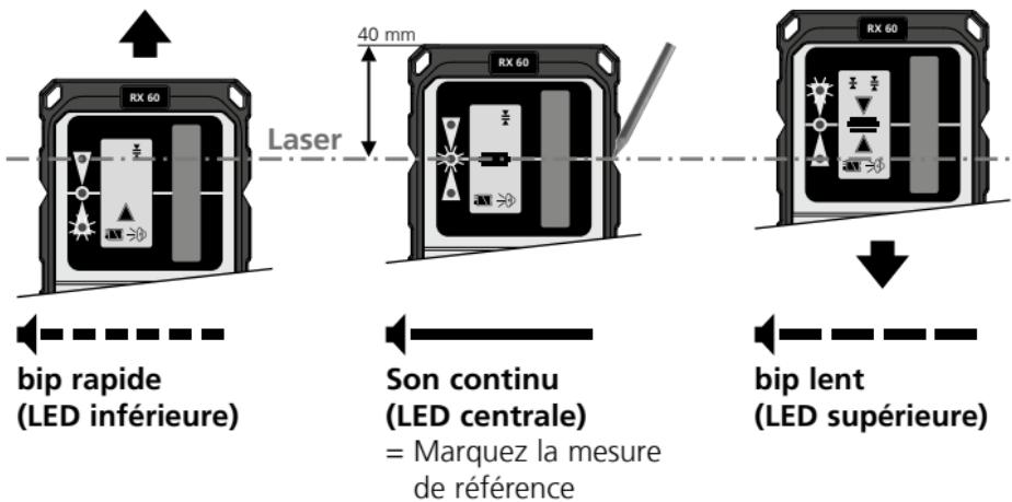
! L'intensité lumineuse des lignes laser est maximale au centre et va en diminuant sur les bords. Cela permet de réduire la plage de réception maximale du récepteur laser.
