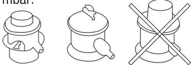
Kuvassa 29-30 mbar matalapaineensäätimet, jotka ovat oikea valinta kaasugrillille sekä oikealla korkeapaineensäädin, joka on tarkoitettu nestekaasutyökaluille eikä sitä saa käyttää kaasugrillissä.
