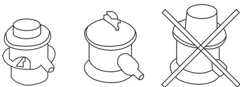
På bildet vises det to lavtrykksregulatorer 30 mbar, som er riktig valg til gassgrillen samt en høytrykksregulator som kun skal benyttes til gassverktøy. Bruk ikke denne til gassgriller.
