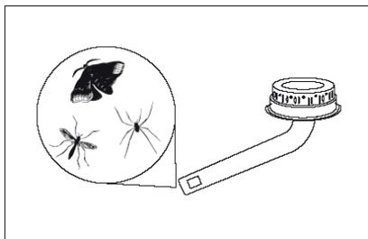
Ifall detta inträffar, stäng av gasventilerna till "OFF" läge och vänta tills grillen är sval. När grillen har svalnat, lösgör brännaren och rengör blandarröret med en borste eller piprensare. Montera tillbaka brännaren enligt råd och försäkra att blandarröret är rätt över ventilen med munstyckena enligt råden. Var noggrann med att blandarröret är korrekt påträdna på ventilen.
