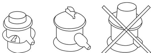
På bilden finns det 30 mbar lågtrycksregulatorer, som är rätt val till gasgrillen samt till höger en högtrycksregulator som får användas endast till gasverktyg. Använd inte den till gasgrillar.
