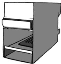
De bodem van de kachel bevat een rooster en daarboven bevindt zich een plaat waarmee de vlammen naar de schoorsteen worden geleid. Deze onderdelen dienen bij gebruik van de kachel altijd te zijn geplaatst. (Zie afbeelding links). De plaat bovenin de kachel mag niet zover in worden geduwd dat de rook niet meer door de schoorsteen kan ontsnappen.
