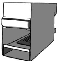
В нижней части печи находится подовая плита, на которой расположена одна колосниковая решётка, а на верхней полке подвешена воздушная направляющая заслонка, которая направляет пламя в трубу. При эксплуатации печи необходимо следить, чтобы все эти части были на месте (рис. слева). Задвижку в верхней части трубы нельзя задвигать слишком глубоко, иначе она будет препятствовать прохождению дыма.
