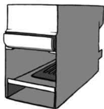
Im Ofen befindet sich am Boden ein Rostgestell mit einem Rost und im Oberregal eine Luftführung. Dahinter gelangen die Flammen in den Schornstein. Sie müssen sich beim Heizen immer im Ofen befinden (Abb. links). Die Stützplatte des oberen Teils darf nicht zu weit hineingeschoben werden, da sonst der Rauchabzug blockiert ist.
