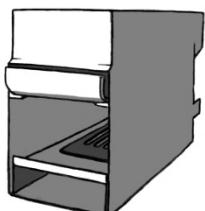
Au fond du poêle, se trouvent un compartiment avec une grille et un conduit d'air sur le rebord supérieur qui dirige les flammes vers la cheminée. Lorsque vous utilisez le poêle, ces pièces doivent toujours se trouver à leur emplacement. (Image de gauche) La plaque pare-feu de la partie supérieure ne doit pas être trop enfoncée afin d'empêcher la circulation de la fumée.
