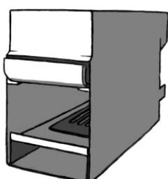
På bottnen i kaminen finns en hylla med en rost, och på den övre hyllan finns en spoiler, som styr lågorna bakåt mot rökröret. Dessa ska vara på plats alltid
