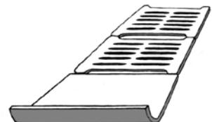
In den MACU-Ofen gehört eine Rostschale, in die ein Gitterrost eingesetzt wird. Dazu kommt im oberen Fach eine Luftklappe aus Eisen, die den Verbrennungsluftstrom im oberen Teil lenkt. Der Ofen darf ohne diese Teile nicht betrieben werden. Beachten Sie, dass es sich um Verschleißteile handelt, die sich im Gebrauch verbiegen und ihre Form verändern. Bei Bedarf können Sie diese durch Ersatzteile ersetzen (Abb. rechts).
