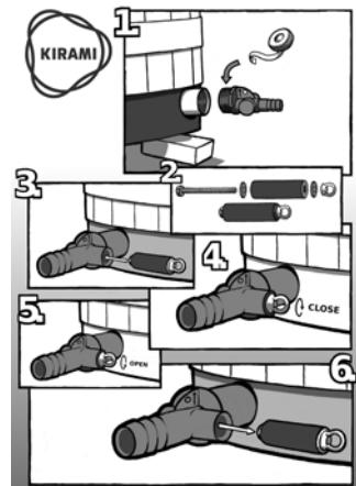
Draai de stop niet onnodig strak aan; draai telkens een halve slag, totdat het lekken stopt. Laat de stop niet gedurende langere tijd strak aangedraaid zitten, om te voorkomen dat hij vast gaat zitten in de afsluiter. Wacht bij het losmaken van de stop een ogenblik, zodat het rubber van de stop wat kan herstellen, dan komt de stop gemakkelijker los, reinig de stop regelmatig..
