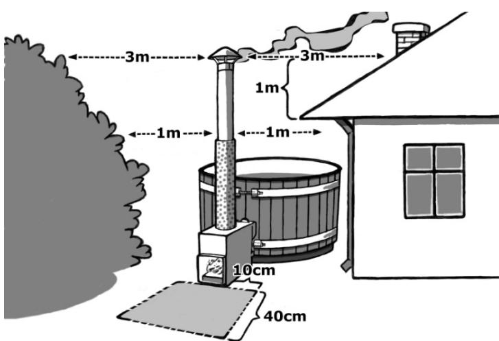
Если купель устанавливается недалеко от домов и построек, например, на краю террасы, необходимо проверить, чтобы дымоход был на противопожарном расстоянии от всех построек и конструкций из легко возгораемых материалов. Расстояние должно быть достаточным как по горизонтали, так и по вертикали, чтобы избежать риска возгорания. В горизонтальном направлении от устья трубы дымохода до легко возгораемых материалов должно быть не менее 3 метров. Другие
