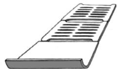
Le poêle MACU est équipé d'un plateau de grille où se place une grille. Un fer à air se place dans la partie supérieure du foyer afin de diriger l'air de combustion. Il est interdit d'utiliser le poêle sans ces pièces. Veuillez noter qu'il s'agit de pièces d'usure qui se tordent et changent de forme au fil de leur utilisation. Vous pouvez commander de nouvelles pièces de rechange pour les remplacer (image à droite).
