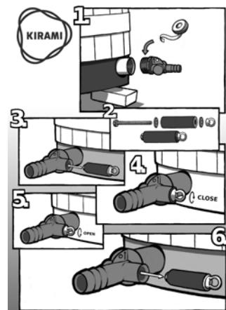
Не вворачивайте пробку слишком туго. Закручивайте ее по полуобороту за один раз до прекращения течи. Не оставляйте пробку надолго в плотно закрученном состоянии, чтобы она не прилипнула к корпусу клапана. При выкручивании пробки подождите немного и дайте резиновому уплотнению вернуться в исходную форму, так пробку будет легче выкрутить.
