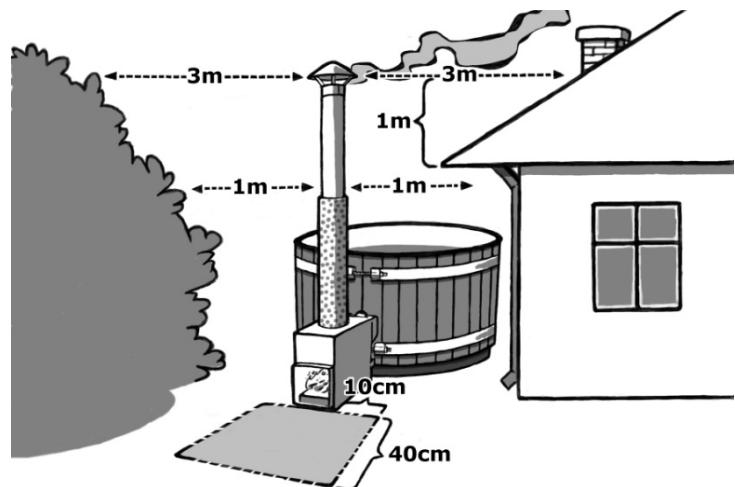
La zone devant et sous le foyer doit être libre de toute matière inflammable. En pratique, utilisez une matière ininflammable dans cette zone, comme le béton, le sable ou une plaque de métal, tel qu'indiqué sur le dessin. Le poêle ne chauffe pas à une température supérieure à celle de l'eau car il est entouré par une couche d'eau. Cependant, la cheminée et le clapet du poêle chauffent. Vous pouvez vous informer plus amplement auprès des pompiers de votre commune.
