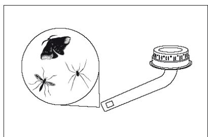
Om detta inträffar, stäng av gasventilerna till "OFF" läge och vänta tills grillen är sval. När grillen har svalnat, lösgör brännaren och rengör blandarröret med en borste eller piprensare. Montera tillbaka brännaren enligt råd och försäkra att blandarröret sitter rätt över ventilen med munstycken enligt råden. Var noggrann med att blandarröret är korrekt monterat på ventilen.
