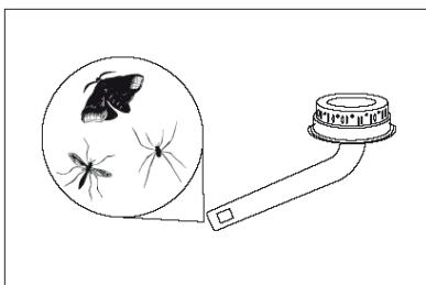
Ifall detta inträffar, stäng av gasventilerna till "OFF" läge och vänta tills grillen är sval. När grillen har svalnat, lösgör brännaren och rengör blandarröret med en borste eller piprensare. Montera tillbaka brännaren enligt råd och försäkra att blandarröret är rätt över ventilen med munstyckena enligt råden. Var noggrann med att blandarröret är korrekt påträdd på ventilen.
