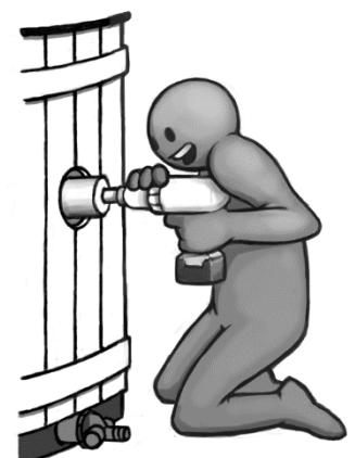
Inloppsgenomföringen tätas mot plastinsatsen med en av de passande medöljande U-profilspackningar som passar tjockleken i plastinsatsen. Avlägsna stickor o.dyl. när du har borrat klart hålen. När genomföringen ansluts till tunnan ska U-profilpackningens kanter sitta på båda sidor om tunnans plastvägg och muttern dras åt väl.
