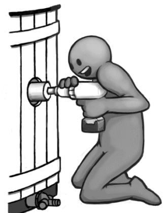
Муфта вставляется в пластик таким образом, чтобы канавка в уплотнении находилась с обеих сторон пластиковой стенки бочки, после этого муфта тщательно затягивается.
