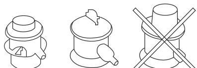
Kuvassa 29-30 mbar matalapainesäätimet, jotka ovat oikea valinta kaasugrillille sekä oikealla korkeapainesäädin, joka on tarkoitettu nestekaasuyökaluiille eikä sitä saa käyttää kaasugrillissä.
