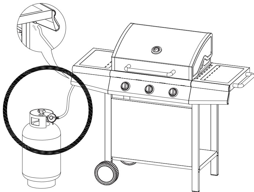
**GB** FOR SAFETY REASONS GAS CYLINDER MAY NOT BE UNDER GRILL, WHILE GRILL IS OPERATED. KEEP GAS CYLINDER NEXT TO GRILL, WHILE GRILL IS OPERATED.
