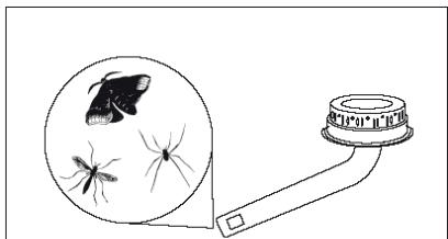
Hvis dette inntreffer, sett bryterne i stilling "OFF" og vent til grillen er blitt kald. Når den er kald kan du løsne brennerne og rengjøre venturierøret med børste og piperenser. Monter tilbake brennerne og forsikre deg om at de entrer inn på gassventilene med dyser.
