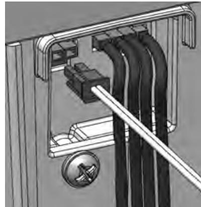
Toalettet må kobles til en strømkilde. Toalettet leveres med en batterieliminator for 110-240 V samt 12 V batterikabler. Uansett valg av strømkilde blir ledningene koblet til baksiden av toalettet via den merkede inngangen på bildet over. Sørg for at kontakten er festet ordentlig.
