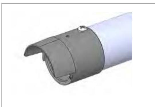
Cuando la salida del tubo esté colocada verticalmente, se debe utilizar el sombrerete de ventilación incluido junto con la rejilla de ventilación, para asegurarse de que la lluvia y la nieve no entren en el tubo.
