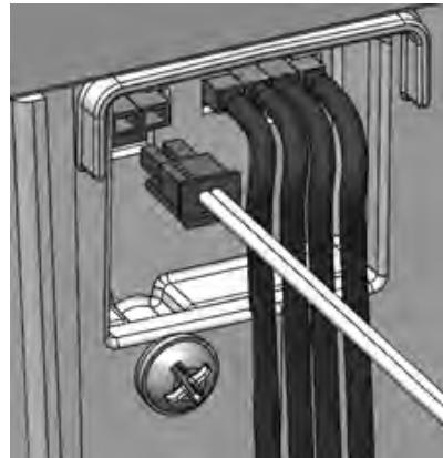
Die Toilette muss an eine Stromquelle angeschlossen werden. Im Lieferumfang ist ein Batterie-Eliminator für 110–240 V sowie ein 12-V-Batteriekabel enthalten. Unabhängig von der Wahl der Stromquelle werden die Kabel an der Rückseite der Toilette am markierten Anschluss – siehe Abbildung oben – angesteckt. Stellen Sie sicher, dass der Stecker gut angebracht ist.
