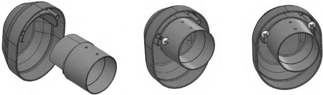
Les pièces assemblées sont ensuite montées comme extrémités de tuyau de la même manière que celle indiquée dans les sections précédentes. Il est également possible d'utiliser la housse de pluie à une extrémité de tuyau horizontale dans des conditions plus exigeantes pour assurer une meilleure protection contre les intempéries et le vent.
