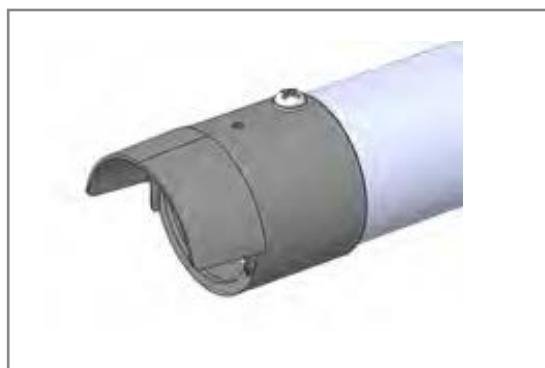
Når rørenden er loddrett, brukes den medfølgende regnhetten sammen med ventilasjonsgitter for å sikre at regn og snø ikke kommer inn i røret.
