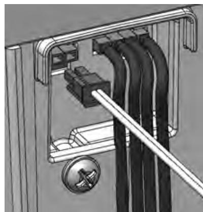
El inodoro debe estar conectado a una fuente de alimentación. El inodoro incluye un eliminador de baterías para 110-240 V y un cable de batería de 12 V. Independientemente de la elección de la fuente de alimentación, el cable se debe conectar en el lado posterior del inodoro, en la entrada señalada en la imagen anterior. Asegúrese de que el enchufe se conecte correctamente.
