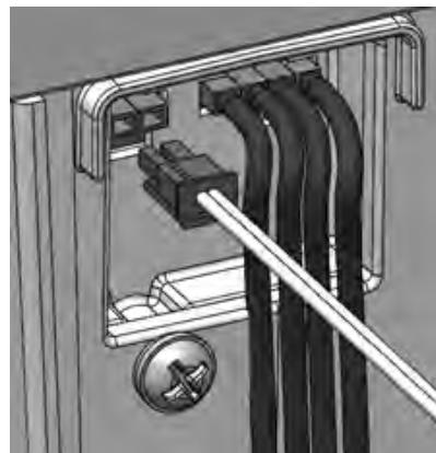
Les toilettes doivent être raccordées à une source d'alimentation. Les toilettes sont livrées avec une alimentation électrique 110-240 V et un câble 12 V. Quel que soit le choix de la source d'alimentation, le câblage est raccordé à l'arrière des toilettes à l'entrée indiquée sur l'illustration ci-dessus. Veillez à ce que les branchements soient correctement réalisés.
