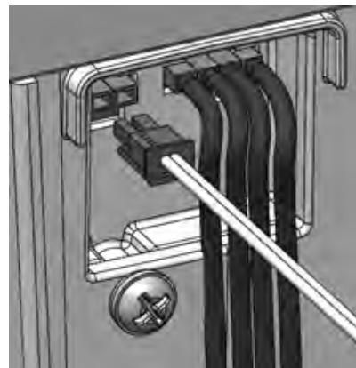
Käymälä on kytkettävä virtalähteeseen. Käymälän mukana toimitetaan 110–240 V:n muuntaja ja 12 V:n akkukaapelit. Virtalähteen valinnasta riippumatta johdot kytketään käymälän takaosaan ylä olevassa kuvassa näkyviin liitäntöihin. Varmista, että liitin kiinnitty kunnolla.
