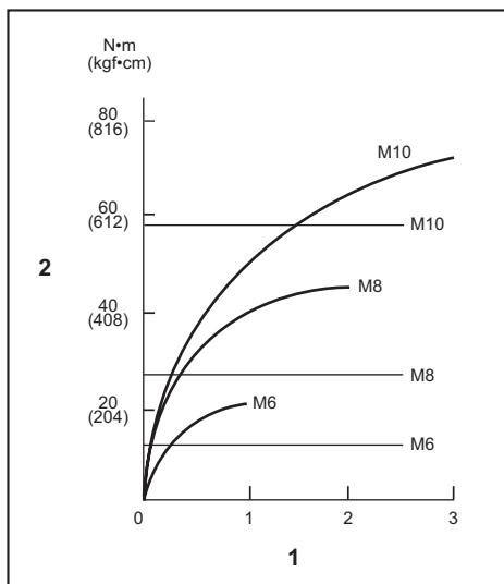
1. Åtdragningstid (sekunder) 2. Åtdragningsmoment
