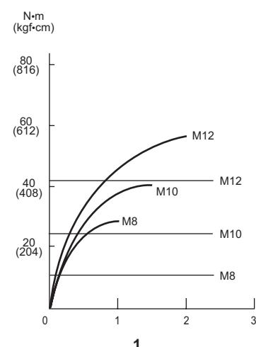
1. Время затяжки (с) 2. Момент затяжки
