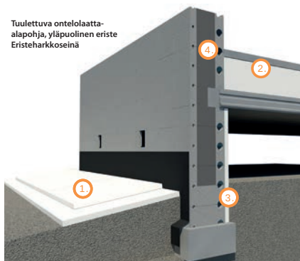
Tuulettuva ontelolaatta-alapohja, yläpuolinen eriste Betonirunko Ohutrappaus
