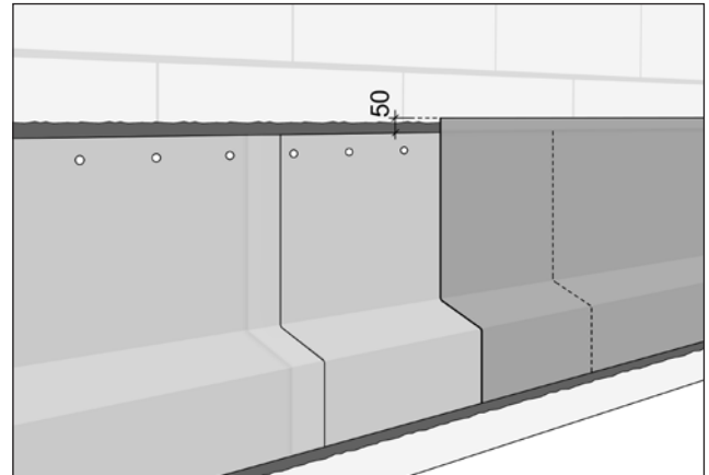
Seuraavat bitumikermi kerrokset.
