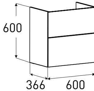
IDO Elegant Compact underskåp har två mjukstängade lådor med push open mekanism eller handtag. Push open och handtag beställs separat. Bredd 600mm, djup 366mm. Finns i stilren vit. Vattenlös och böjbar avloppsslang medföljer. Levereras färdigmonterad. Stommen är tillverkad i fukttrögt spånskiva och fronten fukttrögt MDF. Möbeln passar till IDO Elegant tvättställ 16502 [ej inkluderad i priset] Tillval: LED belysning för lådan.
