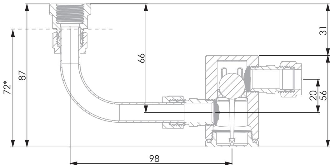
**FI** **Asennus.** Vesilukko liitetään ilmanvaihtokoneen kondensivesiliittimeen. Kondensivesi johdetaan sisähalkaisijaltaan vähintään 12 mm putkella lattiakaivoon, pesupöydän vesilukkoon tai vastaan. Putkea ei saa liittää suoraan viemäriin. Putkessa ei saa olla toista vesilukkoa tai vaakavetoa.
