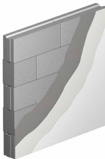
Kuva 40. Kuivan tilan seinä.
