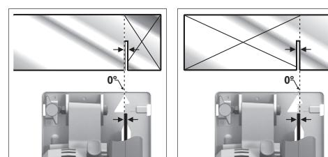
เครื่องหมายตัด (12) และตำแหน่งของใบเลื่อยสำหรับการ ตัด
