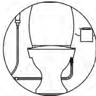
WC-istuimen kytkentä Uponor-kytkentäliitin 16 x 10 (1070705)
