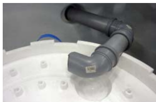
Kuva 6. Vesilukko voidaan ottaa pois käytöstä poistamalla putken kulma tai kääntämällä se kuvan tavalla sivulle.
