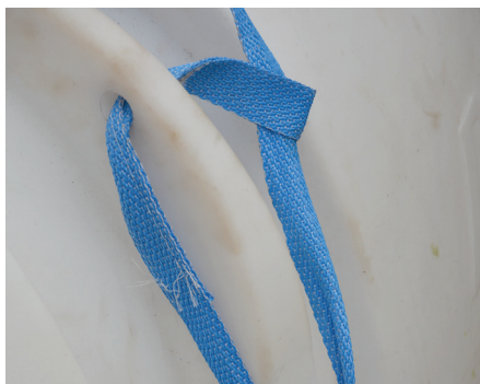
Pujoita liina umpisäiliön ankkurointikorvan läpi.
