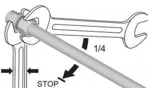
2. Ziehen Sie die Mutter mit einem Gabelschlüssel und ca. 1/4-Umdrehung bis zum deutlich fühlbaren Anschlag fest.
