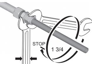
**Montaggio del raccordo rapido con tubo liscio**
