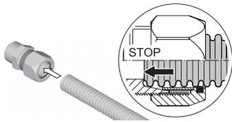
2. Stossen Sie das Wellrohr bis zum Anschlag in die Verschraubung. Achten Sie darauf, dass die Dichtflächen sauber sind.
