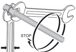
3. Ziehen Sie die Mutter mit einem Gabelschlüssel bis zum fühlbaren Anschlag fest.
