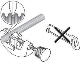
**Montaggio del raccordo rapido con tubo corrugato**
