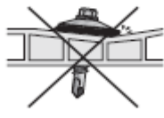
Kuva 13c Väärin – poraus ja asetus ei kohtisuorassa
