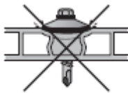
Kuva 13a Väärin – liiallinen kiristys
