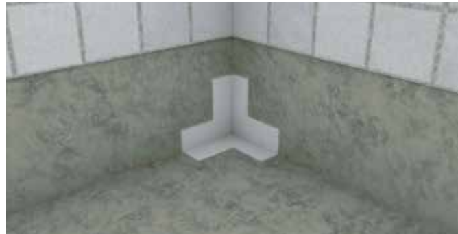
3. Levitä vedeneristettä nurkkakappaleen päälle.
