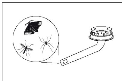
Ifall detta inträffar, stäng av gasventilerna till "OFF" läge och vänta tills grillen är sval. När grillen har svalnat, lösgör brännaren och rengör blandarröret med en borste eller piprensare. Montera tillbaka brännaren enligt råd och försäkra att blandarröret är rätt monterat ventilen med munstyckena enligt råden. Var noggrann med att blandarröret är korrekt monterade på ventilen.
