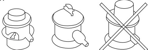
På bilden finns det 30 mbar lågtrycksregulatorer, som är rätt val till gasgrillen samt till höger en högtrycksregulator som får användas endast till gasverktyg. Använd inte den till Gasolgrillar
