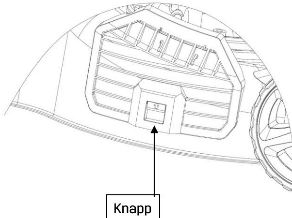
Tryck knappen uppåt, lyft därefter skyddet till sidoutkastet, montera utkastränna.
