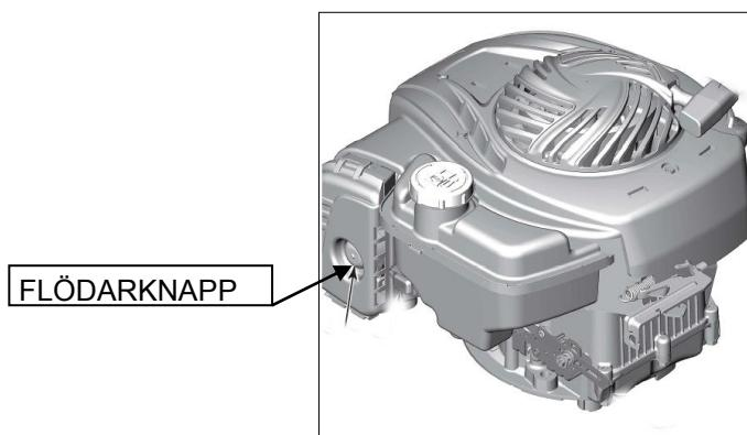
Du bör även tillsätta mer bränsle i luftblandningen för att underlätta start. När du trycker på flödarknappen pumpas bränsle direkt från förgasaren till förbränningskammaren.
