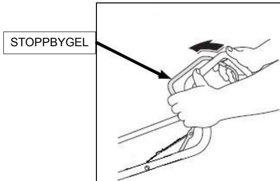
**!** **VARNING!** Kniven fortsätter att rotera under några sekunder efter att motorn har stängts av. Koppla från tändstiftshatten om gräsklipparen ska lämnas utan uppsikt.
